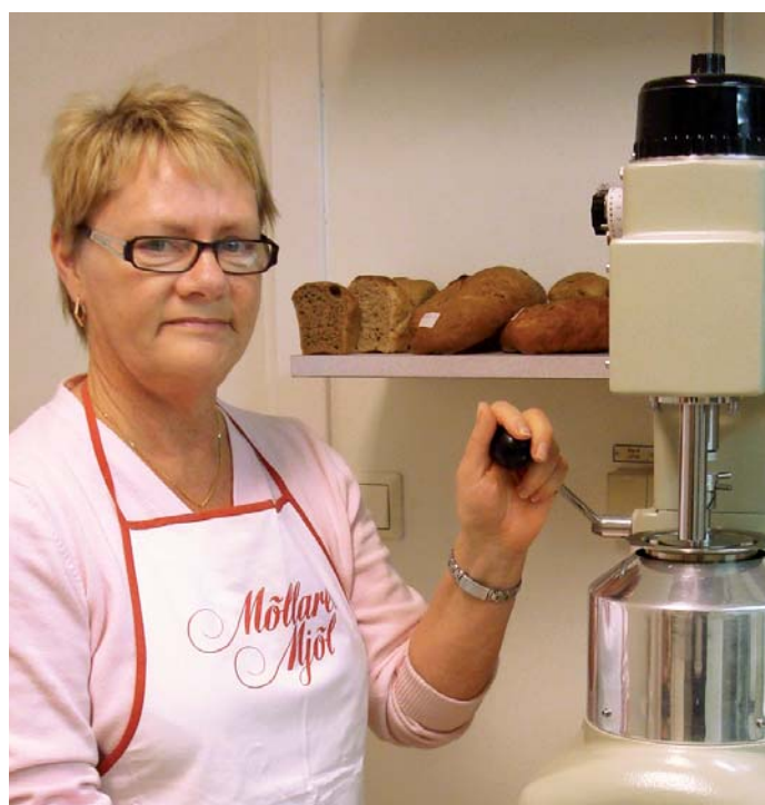
Att våra produkter håller en hög och jämn kvalitet kontrolleras av Eva Ahlbin på vårt laboratorium. På bilden mäter Eva viskositeten på ett mjölprov med hjälp av en amylograf.
